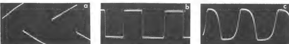
Bild 11. Durchlaß von Rechteckimpulsen über den Mikrofon- und Hauptverstärker bei folgenden Impulsfolgefrequenzen; a) 40 Hz, b) 1000 Hz, c) 10 000 Hz
